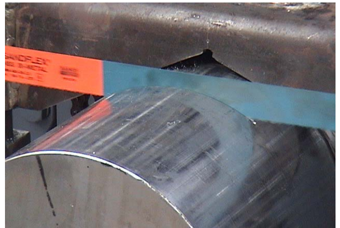
DSC0881.JPG: Corte en frío
